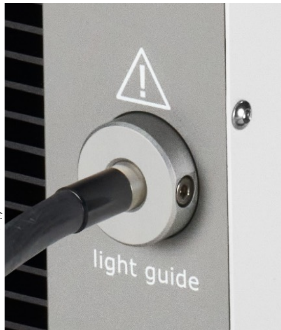
图 2. 3 mm直径的LLG导管插入前面板的输入端口
