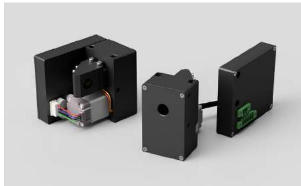
OEM 激光功率衰减器 (LPA-OEM) 是一种紧凑、经济高效的电动激光功率控制单元，专为集成而设计。LPA-OEM 在 250 nm 至 2000 nm 的紫外、可见和近红外光谱范围内适用。该装置结合独特的机械设计
